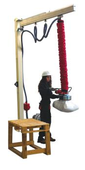
Il Manipolatore a braccio ha la caratteristica fondamentale di poter sostenere carichi a sbalzo, risultando quindi strumento essenziale per poter posizionare oggetti all'interno di macchinari, presse, cabine oppure al di sotto di eventuali impedimenti presenti nell'area di lavoro. Oltre a bilanciare il peso del carico, il manipolatore permette di gestire l'orientamento del pezzo afferrato, come avviene nei casi di movimentazione di bobine e vetri o di svuotamento di fusti e casse.
